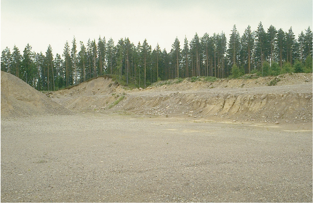
Fig. 31. Grustaget 800 m sydost om Gummarydgölen (9a) är brutet i en liten ås med omgivande flacka ytor med grova, två till tre meter mäktiga lager av stenigt isälvsgrus som vilar på en flack yta av sandig morän. Foto förf. 1996.
