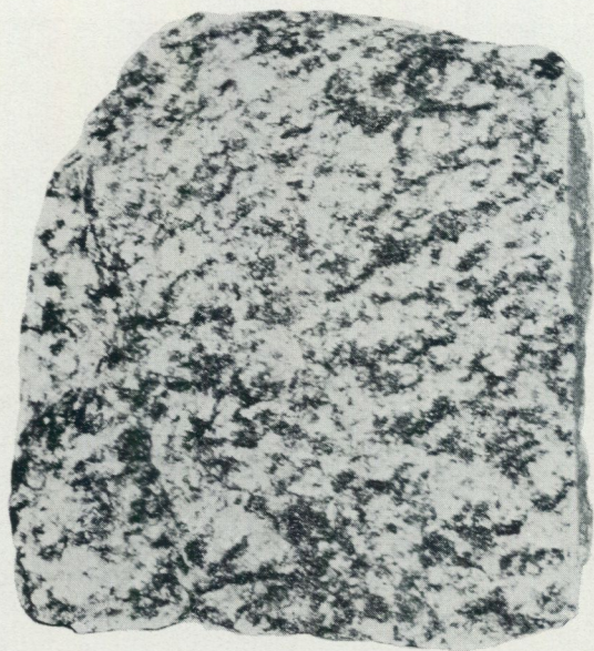
Fig. 9. Grå granodiorit (gnejsgranit). Vägs kärning ca 150 m NO Okna hpl. (8c). 3/4 av naturlig storlek. Foto K.-A. Kornfält
