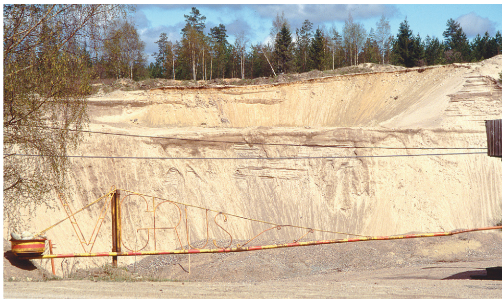
Fig. 26. Horisontella sandlager i skärningen 1200 m ÖSÖ om Göranstorp (0i). På dessa ligger ca en meter svallsand. Vy mot nordöst. Foto förf. 1995.
