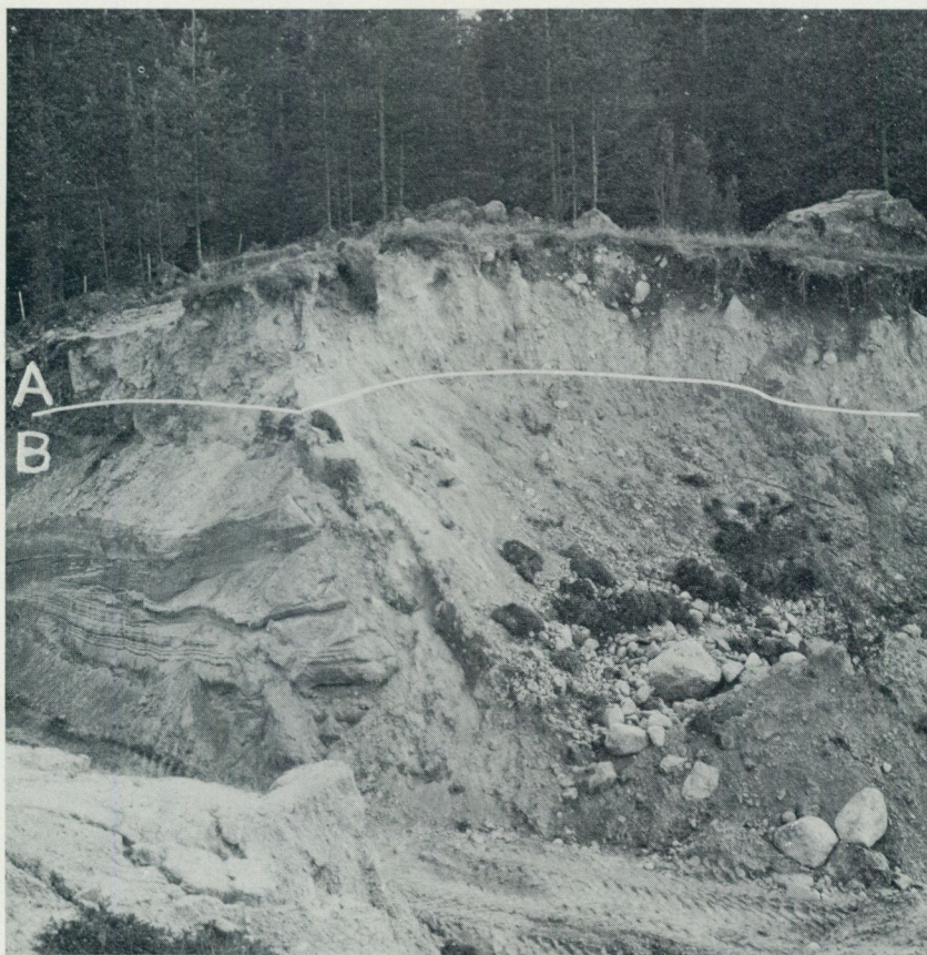
Fig. 10. Isälvsavlagring söder om Övralund (8i). Moränöverlagrad läsidesavlagring. Lager A är grusig-sandig morän med hög stenhalt. Lager B är isälvs sediment, växellagrande 1—3 m tjocka bankar av stenigt grus och skiktad sand. Skärningen är ca 8 m hög. Obs. blockhalten i markytan. Foto förf. 1970.
