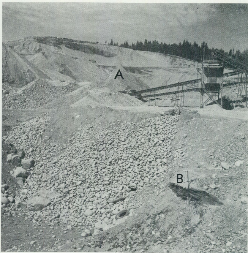
Fig. 11. Grustaget vid Lugnet (1j) sett från söder. Materialet är till stora delar om- lagrat (svallsediment) och inlagringar av lera förekommer på stort djup i åsens sluttningar. Vid A syns ett kvarlämnat parti (med spetsig topp) innehållande glacial lera (jfr fig. 12). Vid B fanns ett skikt av postglacial lera. Foto förf. 1972.
