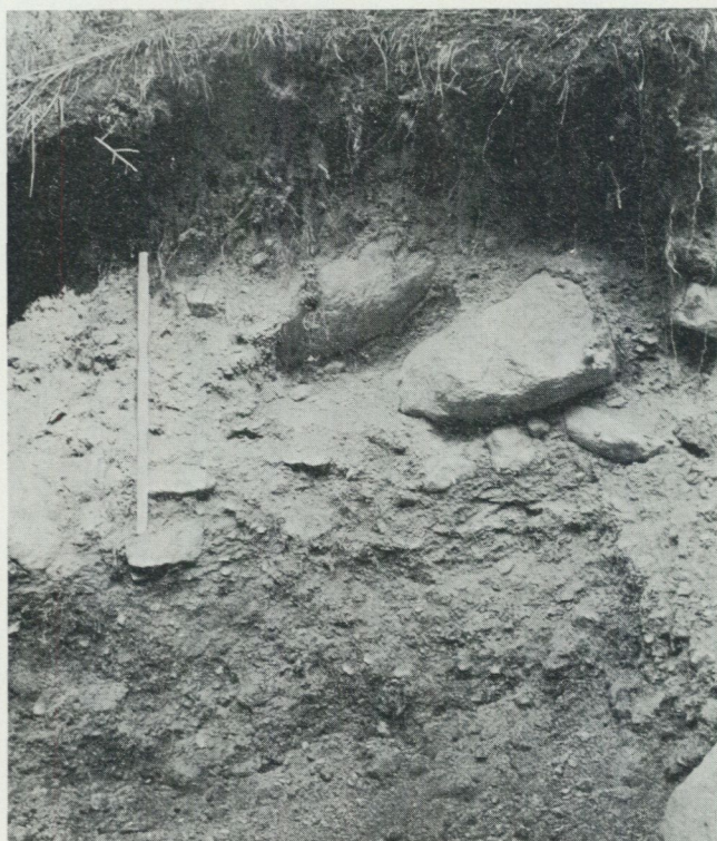
Fig. 7. Skärning 150 m NO om Karlshult (6g) visande ca 1 m morän över stenigt sandigt grus, minst 2.5 m mäktigt. Moränen är sandig-moig och hårt packad. Foto förf. 1972.
