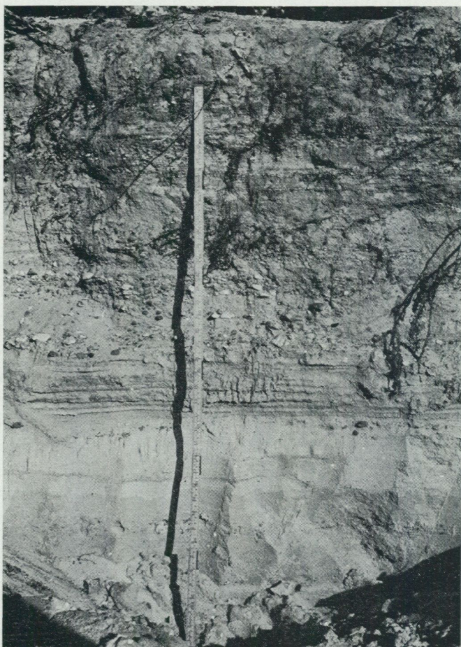
Fig. 16. Skärning i svallsediment 950 m SSV om bron över Falsterbokanalen (9d). Skärningen utgörs av 0.8 m sand med skikt av grus, som vilar på mellansandig grovmo (prov 52 i tabell 1). Foto förf. 1971.
