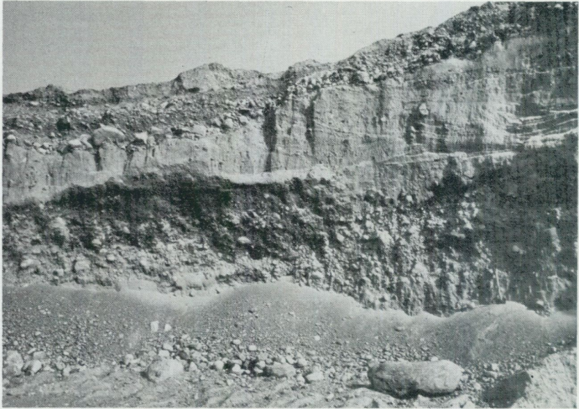
Fig. 32. 4 m hög skärning, vettande mot norr, i grustaget vid Jakobsdal (4f). Det grova lagret under den strömskiktade sanden utgörs delvis av morän. Foto förf. 1972.
