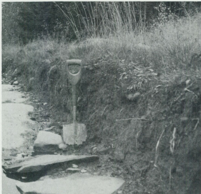
Fig. 8. Tunt moräntäcke på berg vid Lilla Hult (0j). Spaden är 70 cm lång. Foto förf. 1973. Thin till cover on bedrock at Lilla Hult (0j). The spade is 70 cm long.
