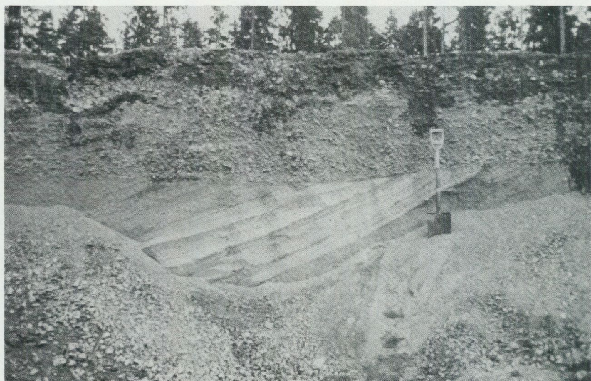
Fig. 15. Grov ytbädd av stenigt grus på deltaskiktad grovmo och sand. Ryaheden, norra vägen i sandtaget 300 m sydöst om Ledsbacken (0i). Foto förf. 1971.
