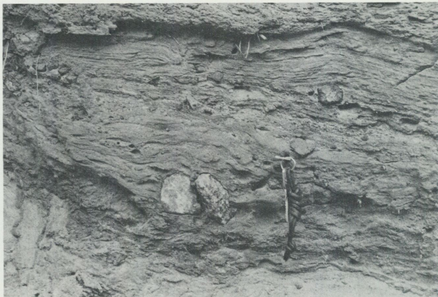
Fig. 4. Skärning i en för denna region ovanlig typ av morän, som bl. a. utmärks av morän- och sedimentskikt (sand och mo) i växellagring. Därunder fanns även ren sand (det undre ljusa lagret på bilden). 1000 m väster om Domargården (2c). Foto S. Björnbom 1974.
