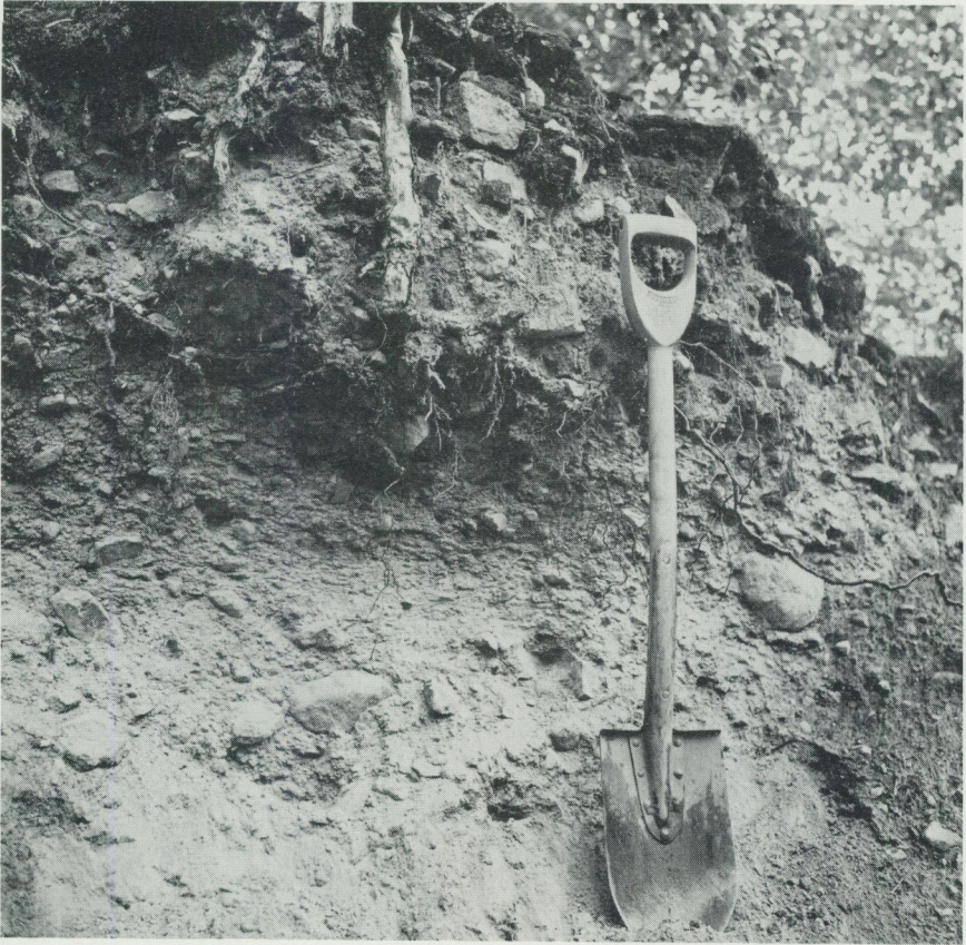
Fig. 5. Skärning i sandig-moig morän med måttlig block- och stenhalt, 150 m norr om Marby (4c). Foto förf. 1973.
