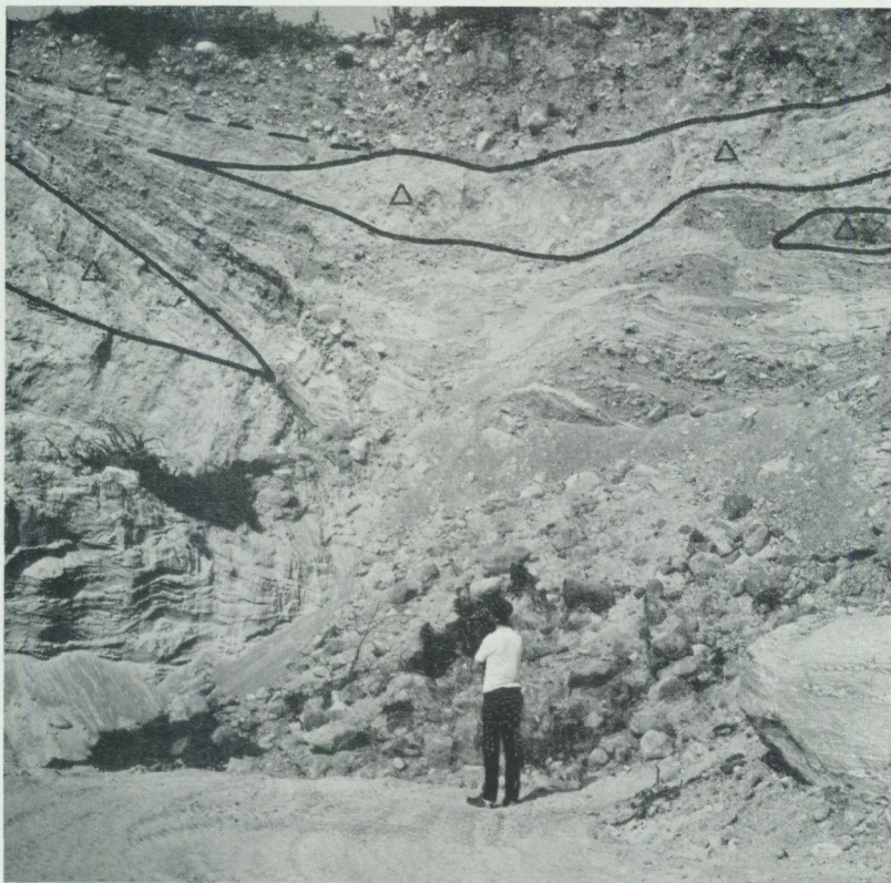
Fig. 20 b. Närbild av fig. 20 a. Bilden är tagen mot ett nästan vinkelrätt hörn av skärningen, tvärprofil till vänster och längsprofil till höger. Ovanpå en bädd av mo ligger lager av sand och grus samt morän (markerad med en triangel). Det översta lagret består av svallgrus. Foto förf. 1974.
