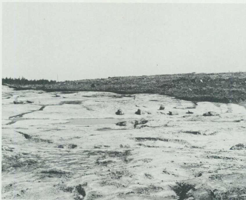
Fig. 8. Vy från södra delen av anläggningsområdet för Landvetter flygfält, ca 500 m sydväst om Kroksjön (9h). Det tunna moräntäcket återspeglar väl berggrundsmorfologin. Frekvensen av block större än 1 \text{ m}^3 är låg. Foto förf. 1975.
