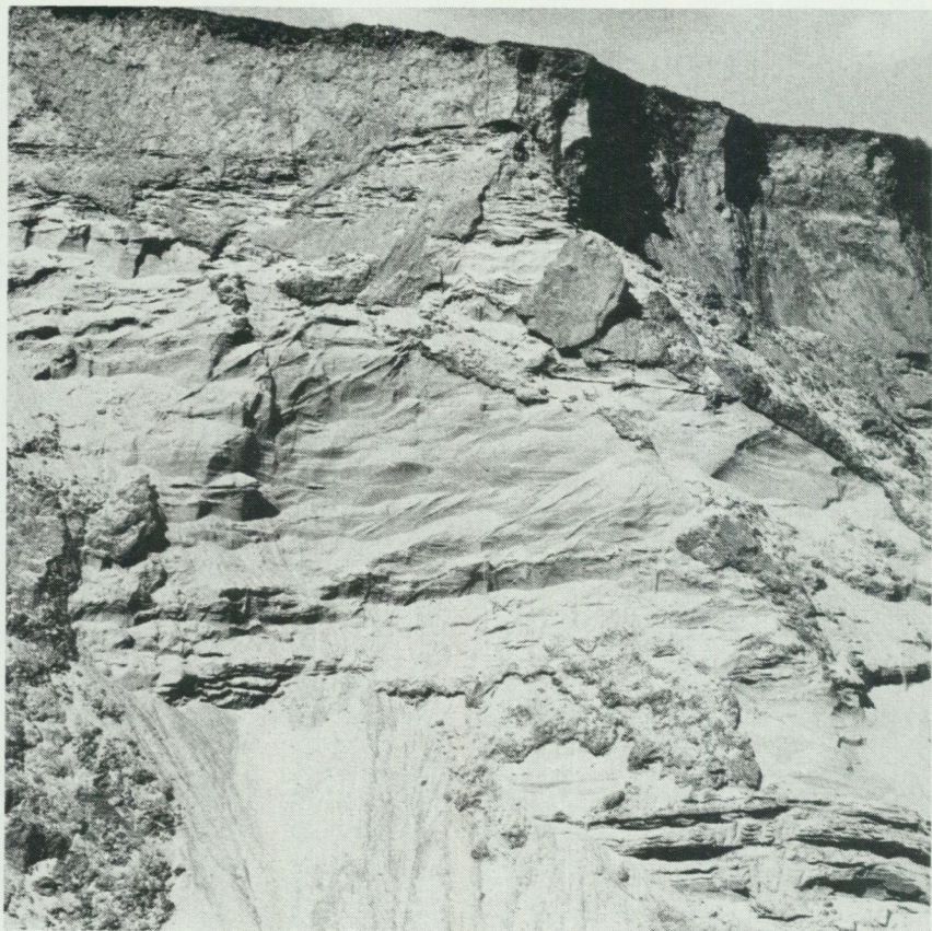
Fig. 30. Skärning i intermoräna sediment bestående av grovmo 300 m ONO om Hälledal (3h). Den täckande moränen är 1 — 2 m mäktig. Foto förf. 1973.
