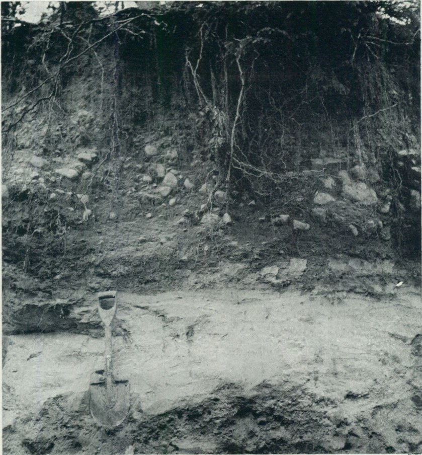
Fig. 27. Skärning, 600 m NV om Norrgården (3j), visande en i moränsluttningarnas nedre delar vanlig typ av lagerföljd. Lagerföljd från ytan: svallsand, stenigt svallgrus, svallgrus, glacialt finkornigt sediment (=ljus lager vid spaden), morän. De finkorniga glaciala sedimenten, som i detta fall representeras av varvig finmo, tunnlar ut och upphör efter en relativt kort sträcka uppåt i sluttningarna, så att svallsediment kommer att vila direkt på morän. — Foto H. Möller 1963.
