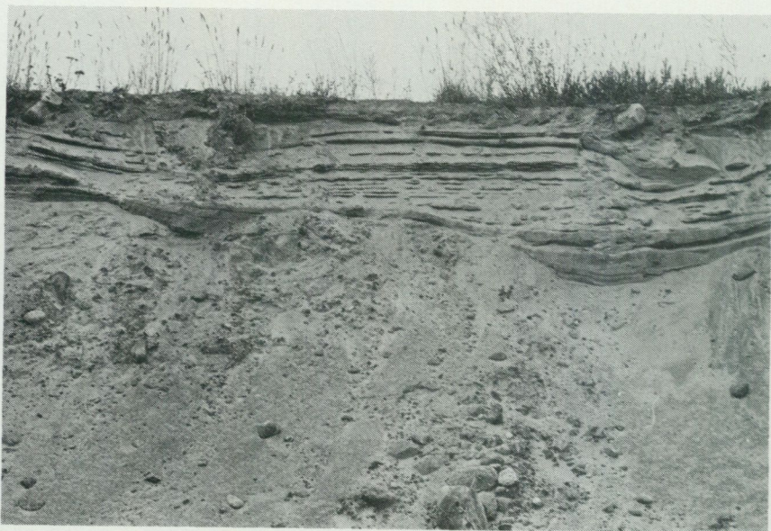
Fig. 20. Finkorniga isälvssediment, sand och mo, i centrala delen av grustaget Höge ås (6j). De överlagrande grova sedimenten är utbrutna och de tydligt skiktade finkorniga bankarna, som har stor utbredning, ansågs delvis vara alltför finkorniga för att vara intressanta ur grusförsörjningssynpunkt. Foto förf. 1979.
