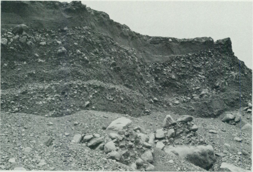
Fig. 15. Norra väggen i grustaget 400 m SSV om Plattekärr (9f). Materialet består av stenigt grus, vilket ibland överlagras av sand. Foto S. Ekberg 1979.
