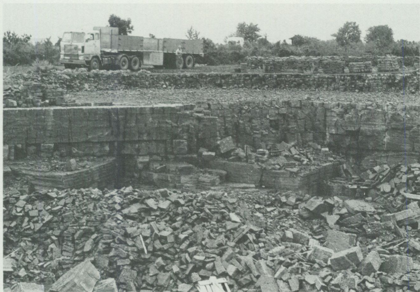
Fig. 4. Kalkstensbrottet vid Johannesberg (0a). Kalkstensens översta lager är kraftigt uppspruckna på grund av karstvittring och därför är brottet, efter öländska förhållanden, ovanligt djupt. Foto förf. 1979.
