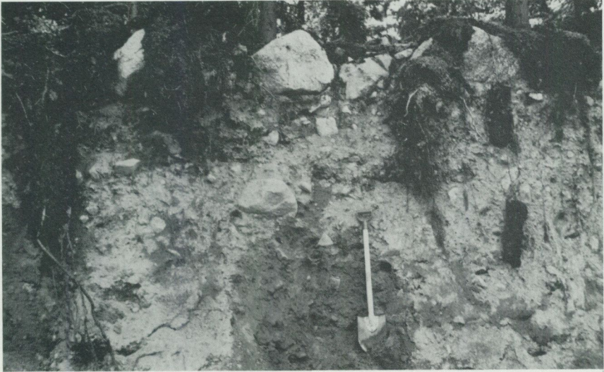
Fig. 7. Skärning i sandig-moig morän 250 m sydost om Sätra (0a). Moränen är hårt packad och har i övre delen en viss skiffrighet, s.k. presstruktur. Block- och stenhalten i moränen är måttlig medan markytan är närmast blockrik. Foto förf. 1981.
