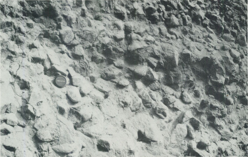
Fig. 26. Skärning i isälvs sediment med utpräglat bimodal kornstorleksfördelning. Grustag 400 m söder om Muggebo (4e).
