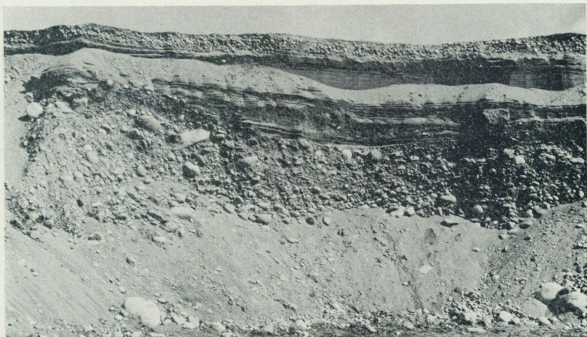
Fig. 21. Skärning i Karlslundsåsen nära norra kartbladskanten vid Nybacken (4 c). Överst swallgrus, därunder delvis bevarad tunn glaciälera, därunder skiktad isälvssand. Underst mäktigt stenigt isälvgrus. Foto E. Fromm 1967.
