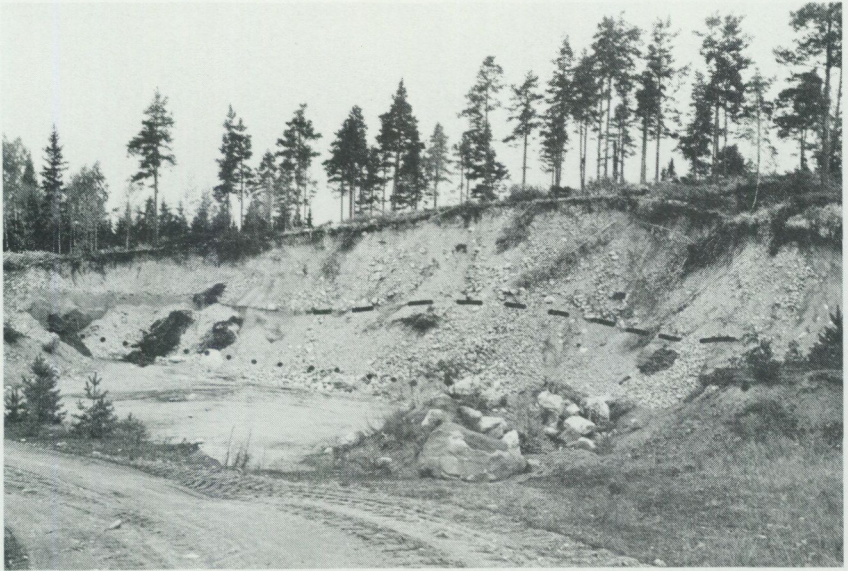
Fig. 13. Isälvsavlagring med ovanlig lagerföljd. Skärning 250 m SSV om Ekelund (9b). Ovanför den streckade linjen block- och stenjord, därunder sand och sandigt grus. Den prickade linjen markerar ett tunt lager av glacial lera (se vidare i texten). Foto mot NV.
