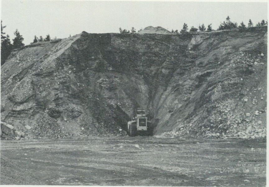
Fig. 14. Del av en nästan 15 m hög skärning i grustaget ca 500 m sydost om Igersdela (6c). Sedimenten är grova och består huvudsakligen av stenigt grus. Foto förf. 1978.
