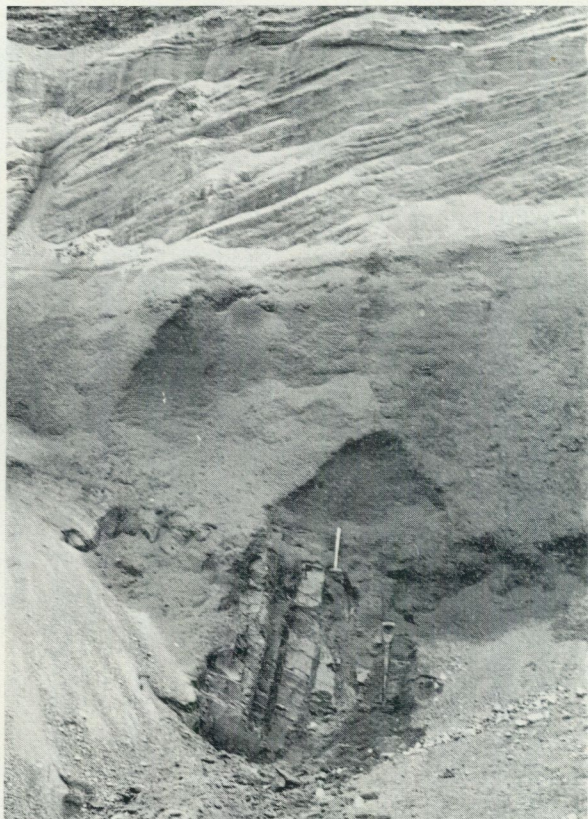
Fig. 13. Varvig lera under 1.5 m stenigt grus och ca 4 m sand i ett grustag öster om Barnmossens norra del (5 c). Det omkring 1 m tjocka lerlagret ligger skålförmigt och är troligen avsatt i en åsgrop. — Foto E. Magnusson 1967.
