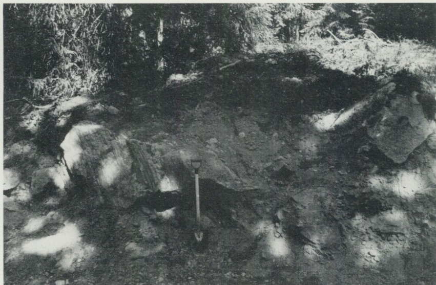
Fig. 7. Skärning i flack moränkulle av grusig-sandig dödismorän 1500 m väster om Hagalund (5c). Lägg märke till de stora kantiga blocken. (Se prov nr 4 i tabell 1.) Foto förf. 1983.
