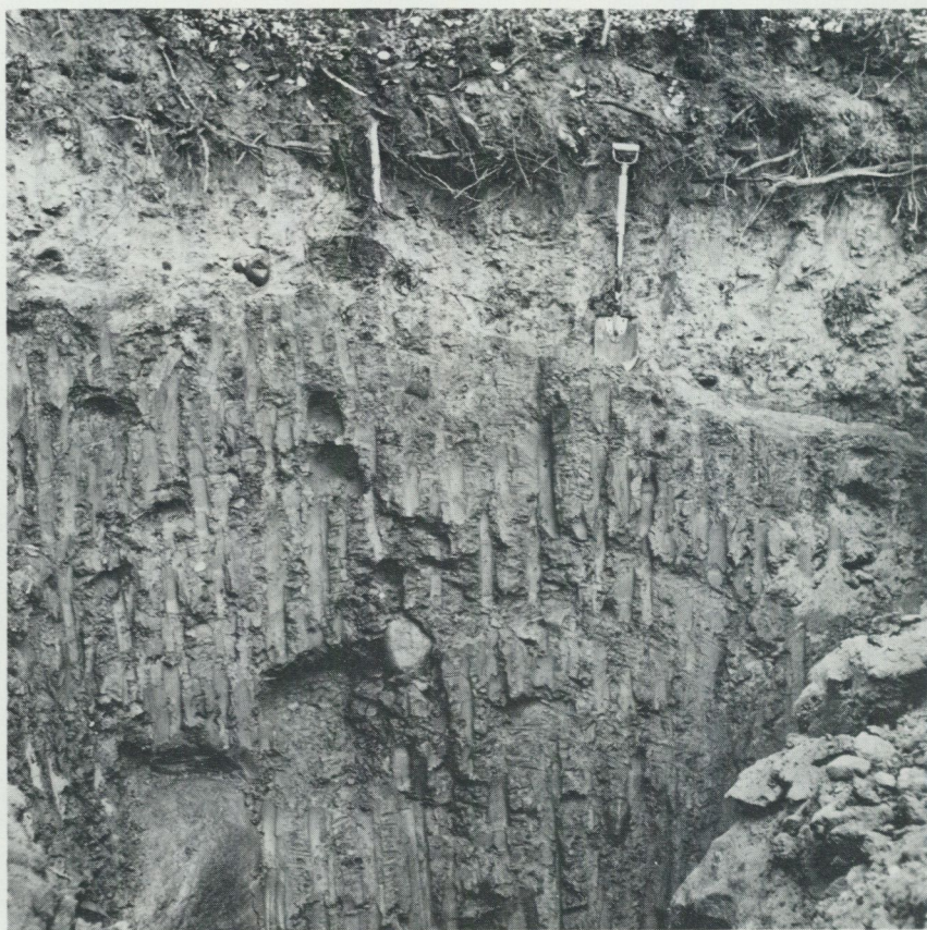
Fig. 11. Den ler- och kalkstensrika Korsarödsmoränen 1600 m OSO om Karlarpsby järnvägsstation (1c). Moränleran täcks av en meter sandig-moig morän. Foto B. Ringberg 1983.
