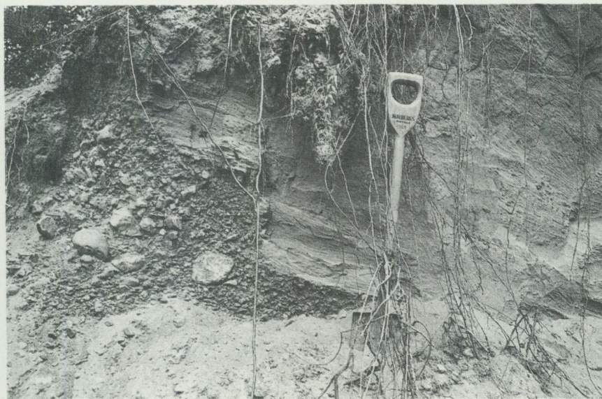
Fig. 14. Grustaget 800 m SSV om Löckerumsdal (8a). Trappstegsformade sättningsstrukturer i grus- och sandlagren. Foto förf. 1986.
