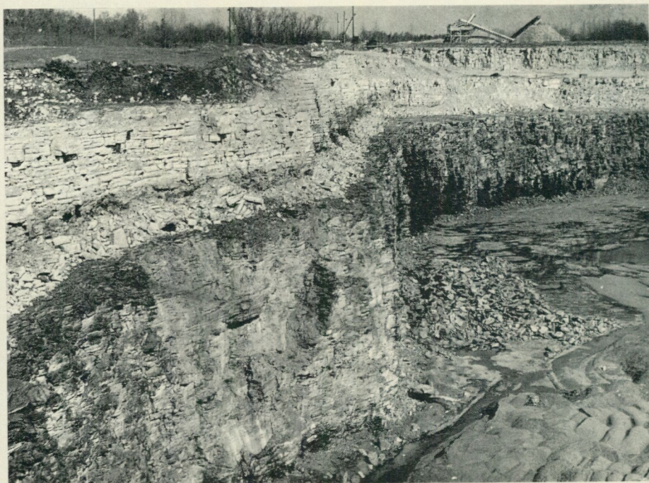
Fig. 15. Hynnebergsbrottet. Den större, undre delen av brottväggen består av alunskiffer (olenidskiffer). Ovanför denna ligger planilimbatakalkstenen. Överst, under moränen, syns den ljusa, mera tjockbankade limbatakalkstenen, som i bakgrunden bildar den övre pallen. Foto P. H. Lundegårdh 1966.
