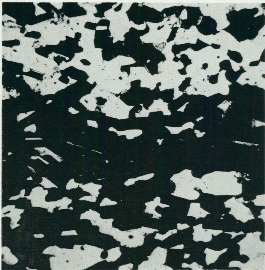
Fig. 55. Blodstensmalm. Svart: hematit, vitt: kvarts, ljusgrått: färglös glimmer. Genomfallande ljus, 45 \times förstoring. Pershytte Storgruva (9a), Nora bergsförsamling. Foto H. Hübner.
