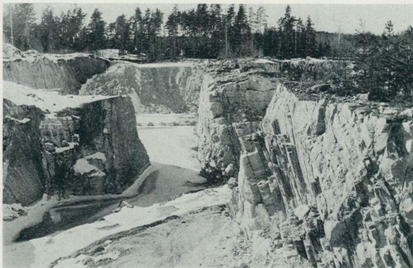
Fig. 6. Dolomiten i det norra marmorstråket vid Glanshammar tillhör ett bergsgrundsområde med genomgående brant till medelbrant nordlig stupning. Björka stenbrott (5 f).
