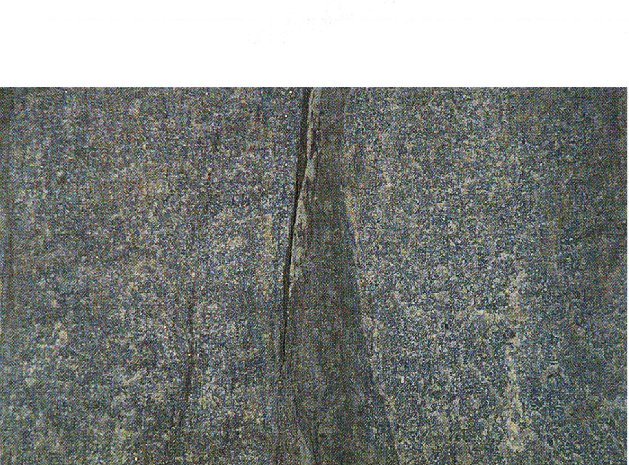
Fig. 2. Sedimentådergnejs. I bergarten finns glimmerhorisoner av växlande tjocklek. Heterogeniteten gör att kvaliteten blir lägre. LEP 950004.
