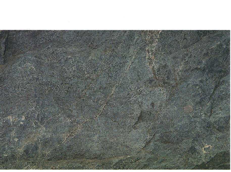
Fig. 4. Svart, finkornig metabasit. Hård och seg, dock ofta lättvittrad bergart. Den har hög densitet. LEP 9500020.
