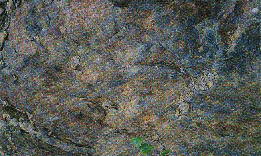
Fig. 1. Parti av glimmerskiffer i tonalit. Notera rostfärgningen och omvandlingen i den kraftigt uppspruckna glimmerskiftern. Bergarten har låg hållfasthet. LEP 950008.
