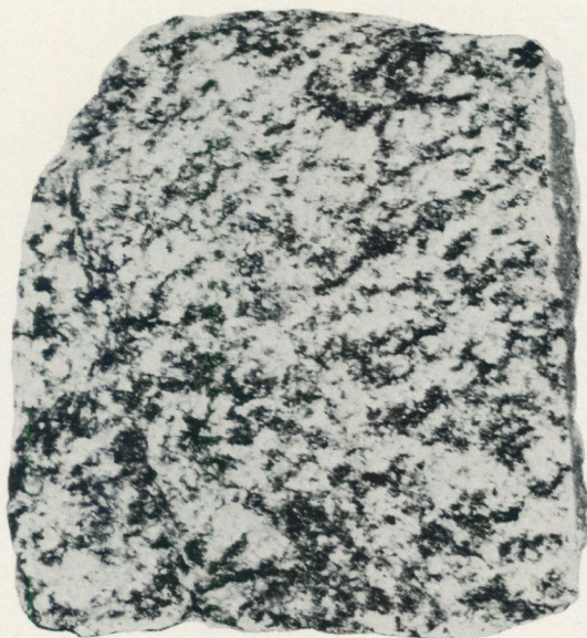
Fig. 7. Grå, svagt skiffrig granodiorit (gnejsgranit). Vägskärning ca 150 m NO om Okna hållplats (8c). \frac{3}{4} av naturlig storlek. Foto K.-A. Kornfält. Grey, weakly foliated, synorogenic granodiorite.
