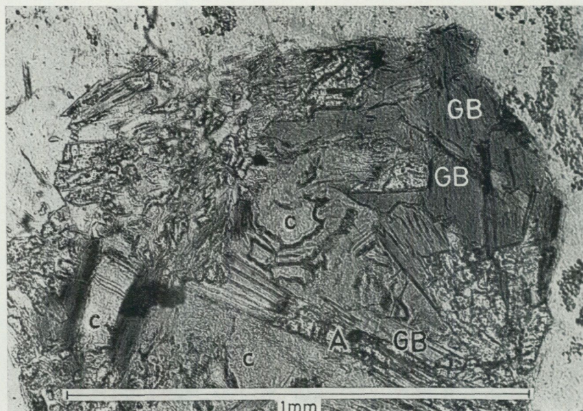
Fig. 30. Sammanväxning av pinitiserad cordierit (C), grön biotit (GB) och andalusit (A) i neosom i sedimentgnejs, Hagalund (1b). 1 nic. Foto L. Persson.
