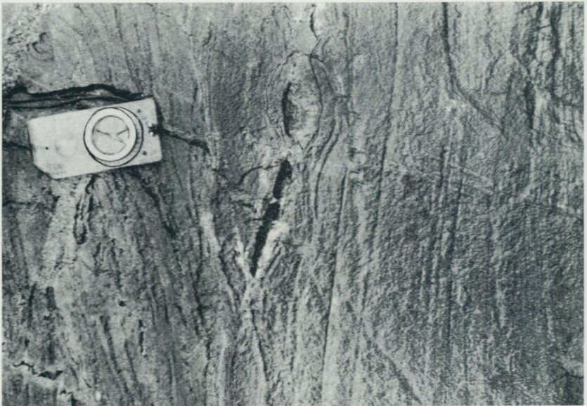
Fig. 3. Flertalet av bladområdets ytbergarter kännetecknas av mycket väl markerad skiktning och andra sedimentära avlagringsstrukturer. Bilden visar fältspatrik gnejs med drygt 25 % kvarts och 15 % glimmermineral. Fördjupningarna mitt på bilden har bildats genom selektiv utvittring av skarniga körtlar. 500 m SO om Duseborg (2f).
