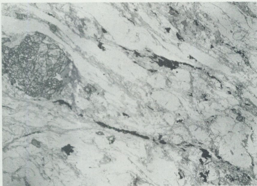
Fig. 27. Mikrofoto av mylonit II. Vasamossen (2j). Den yngre mylonitiseringsen har bl. a. dragit ut magnetiten till svarta stråk av små korn. 25x. 1 nic.
