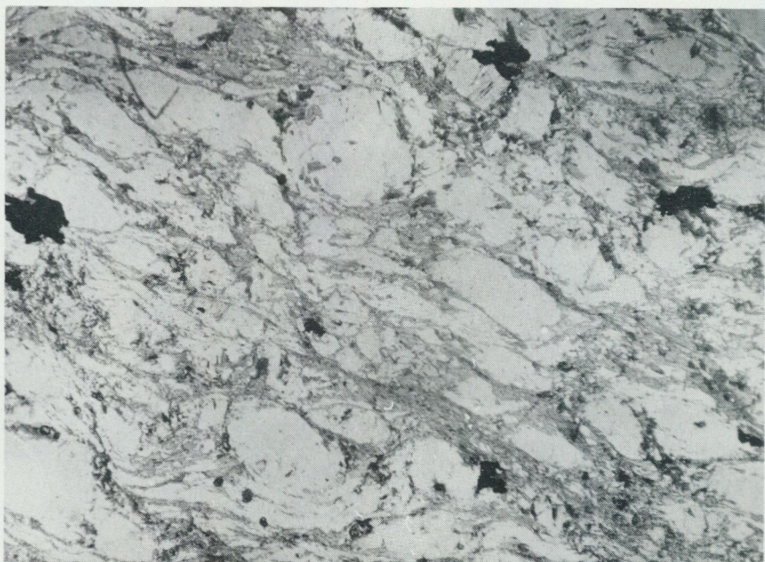
Fig. 26. Mikrofoto av mylonit I. Vasamossen (2j). Den svarta magnetiten finns i kristallaggregat, som vuxit över mylonitstråken. 25x. 1 nic.
