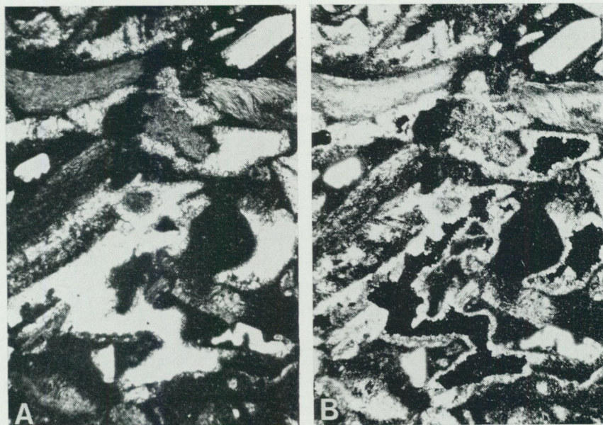
Fig. 26. Grov kalkarenit (skalgruskalk) bestående främst av brachiopodfragment och finkornigt matrix (mellanmassa). Figuren visar hur porerna är utfyllda med kalcitcement endast i mycket ringa utsträckning. A. — nic., porerna helt vita. B. + nic., porerna helt svarta med kalcitcementet framträdande som en gråvit bård. Ignaberga nya kalkstensbrott. X 25. Foto B. Sundquist.
