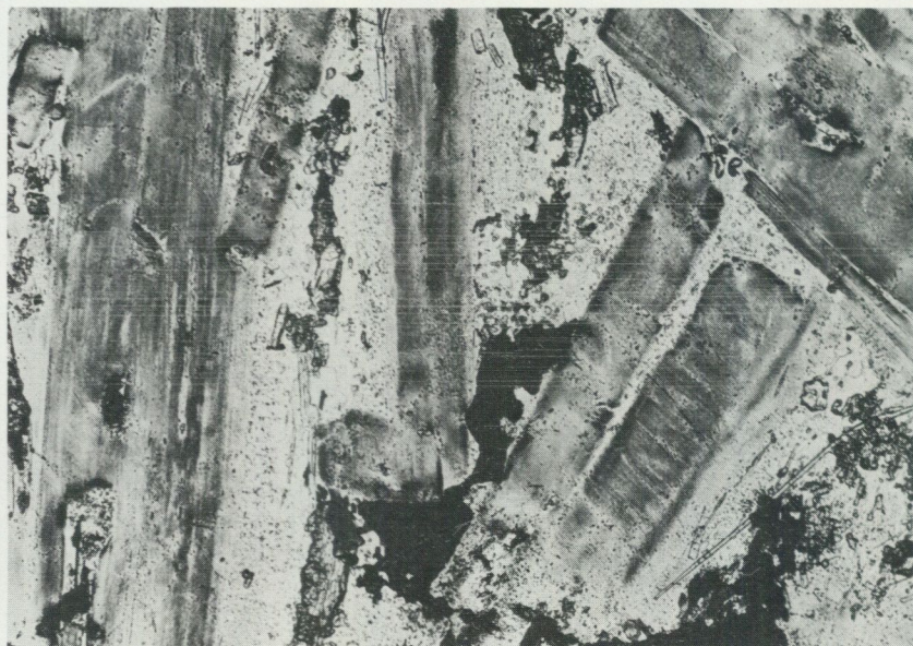
Fig. 18. Plagioklaslister i hyperitdiabas, kraftigt pigmenterade av Fe-Ti-mineral. 2 nic., 25X. 600 m N om Rumperöd (9j). Foto Hugo Wikman.
