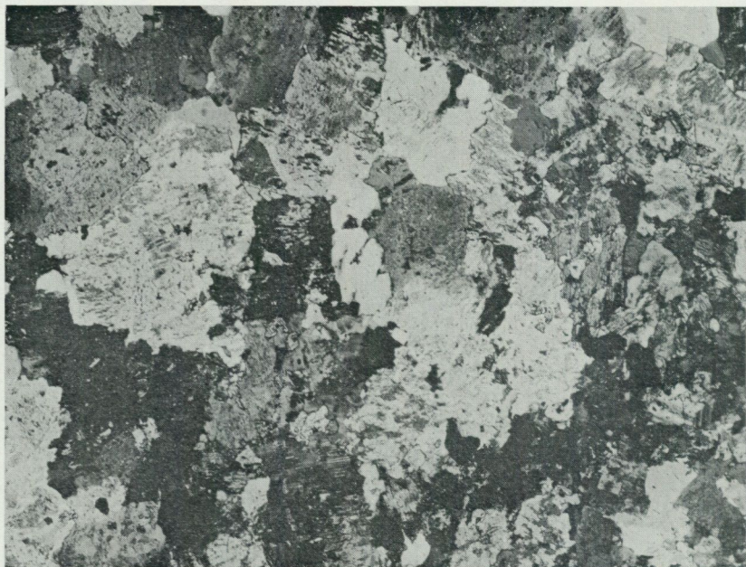
Fig. 43. b) D:o detalj av grundmassan, som övervägande består av "eutektperitisk" mikroklin samt något hornblände och kvarts. + nic., \times 27 .
