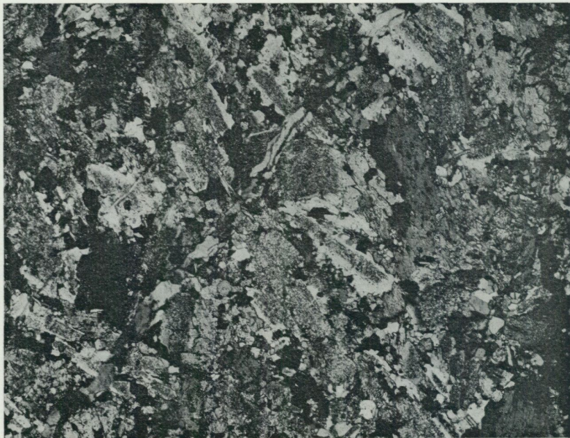
Fig. 31. Hornbländeandesit med starkt sericitiserad plagioklas. + nic., \times 25 . Luukajoki, ca 3 km SSV om Mettjärn (2d).
