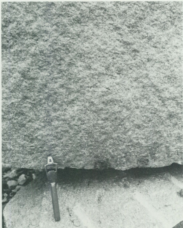
Fig. 9. Fältspatrik granit som kristalliserat om till aplitgranit. Brämhult (0g). Feldspar-rich granite which has recrystallized to aplitic habitus.
