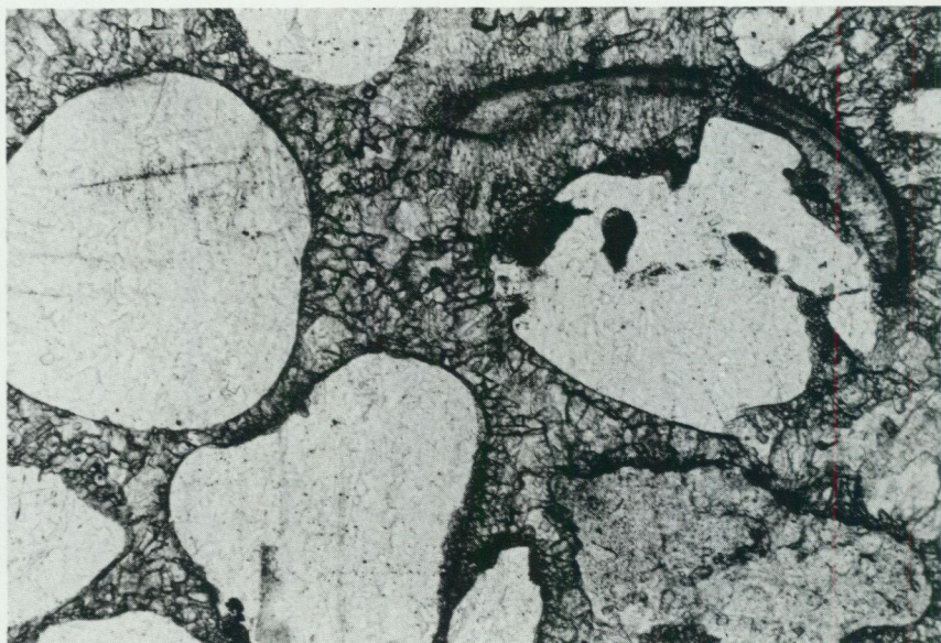
Fig. 48. Slipsnitt av Lundasandsten ur borrmaterial från borrhningen vid Hillehögstinstitutet (0c; 62045/13138), 80 m. Foto Leif Carsrud. Bergartsbeskrivning (1 nic. X85): En måttligt sorterad sandsten (kalkarenit) med subangulära kvartskorn och fossilfragment i en calcitisk mellanmassa. Kalciten är omkristalliserad. Porositeten är 0%. Troligtvis avlöses ovan nämnda sedimenttyp av lager med hög porositet, vilka saknar en calcitisk mellanmassa.
