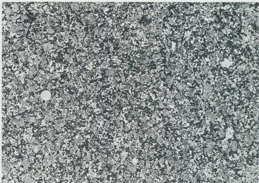
Fig. 80. Grovporfyrisk Filipstadgranit. En del av mikroclinkornen har vita "mantlar" av plagioklas och i en del korn kan man också se inre skal av plagioklas eller biotit. Segersberg (4a). 652355/145480.
