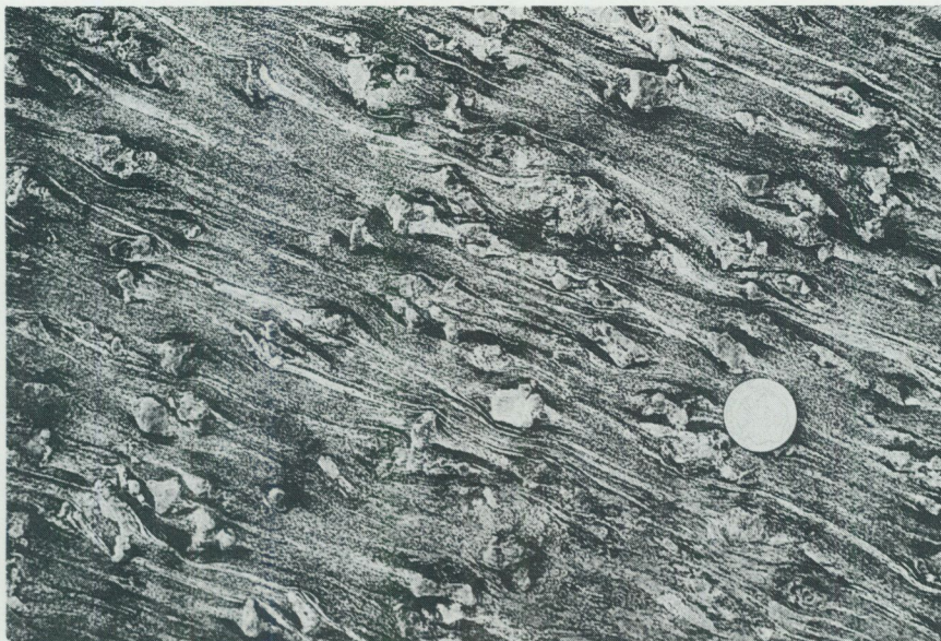
Fig. 54. Andalusitporfyroblaster i glimmerskiffer. 750 m väster om Tösnahult (6d). 653450/146710. (Löst block.)
