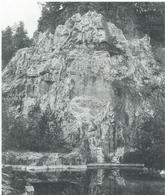
Fig. 10. Limbergets stenbrott (4j), norra väggen. Kontakten mellan underliggande, ljus kalksten och överliggande grå vulkanit (mörk i bilden) syns överst i brottet. Den stupar här ca 20° mot norr. Mäktigheten på den överliggande vulkaniten är i skärningen ca 2 m. 657495/144930.
