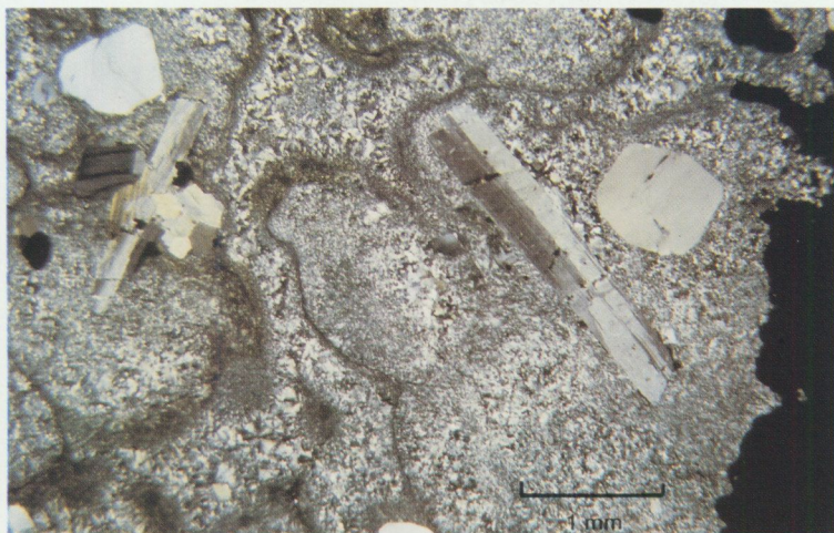
Fig. 12. Euhedral, delvis glomerofyriska albitströkorn i finkornig matrix med begynnande sfärlitbildning. De mörka ränderna utgörs av magnetit. Spikhöjden (4h). 66243/14377.
