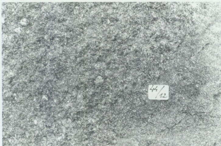
Fig. 10. Kristall-litisk lapillituff. Etiketten är ca 20 mm bred. Block 250 m sydöst om Abborrtjärn (4h). 66233/14382. Crystal-lithic lapilli tuff; width of label c. 20 mm.
