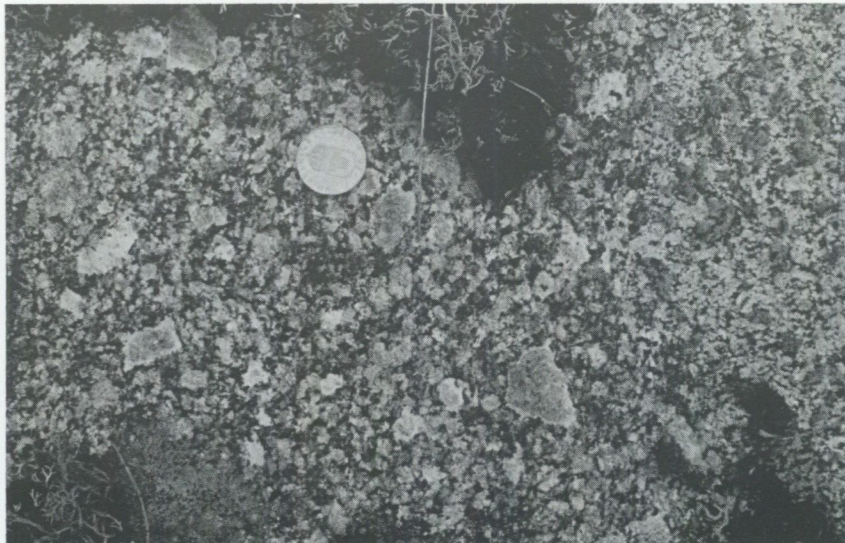
Fig. 36. Kontakt mellan den "kvartsnoppiga" granodioriten till höger och porfyrisk Askersundsgranit till vänster. En påtaglig rikedom av plagioklasmantrade fältspater i Askersundsgraniten kan observeras. Ingen distinkt ålderskillnad kan utläsas ur denna kontakt. 400 m sydsydväst om St Isåsen (3h). 651670/143745.
