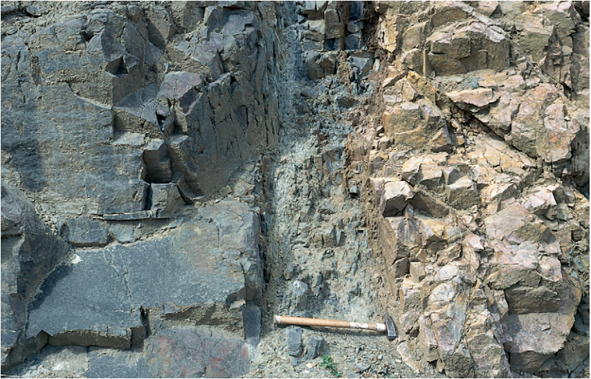
Fig. 68. Kraftigt störd kontakt mellan diabas och gnejs. Dalby stenbrott 617230/134755. Foto Hugo Wikman.
