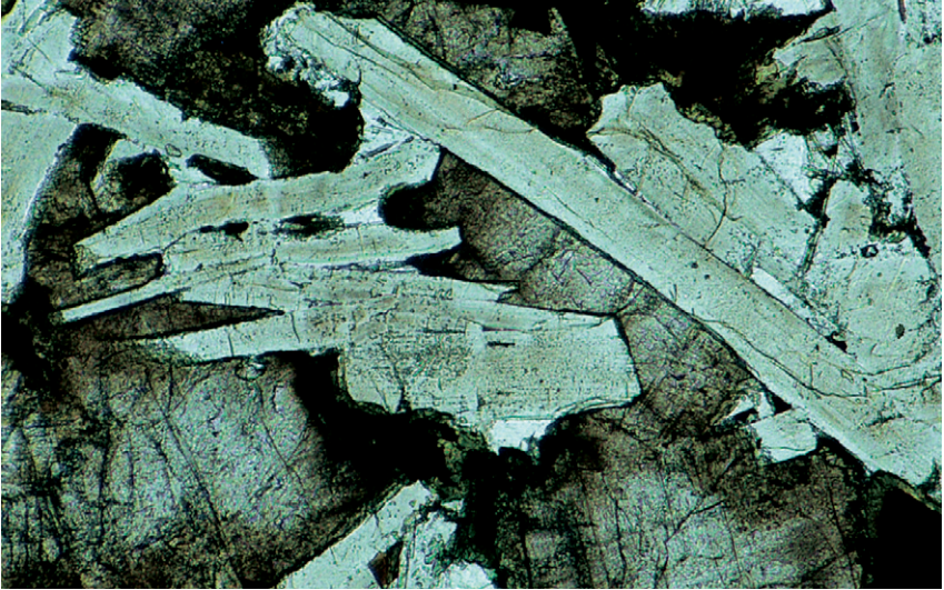
Fig. 13. Brunfärgade plagioklaslister och augitkorn i hyperitdiabas. Mikrofoto 1 nic. 25X. Billebjärs stenbrott, 617615/134348. Foto Hugo Wikman. Pigmented plagioclase and augite in hyperite dolerite.
