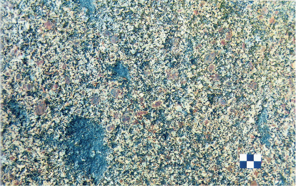
Fig. 43. Ögonförande Smålandsgranit med mantlade kalifältspatögon. Små basiska enklaver. 150 m NV Lindhem (9e), 634765/142055.
