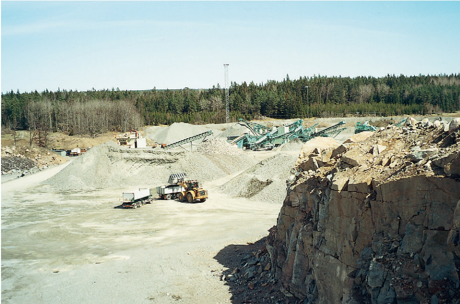
Fig. 33. Bergtäkt i tonalit, makadamframställning. Olunda. 5c, 662885/161480. Quarry in early orogenic tonalite, aggregate production.
