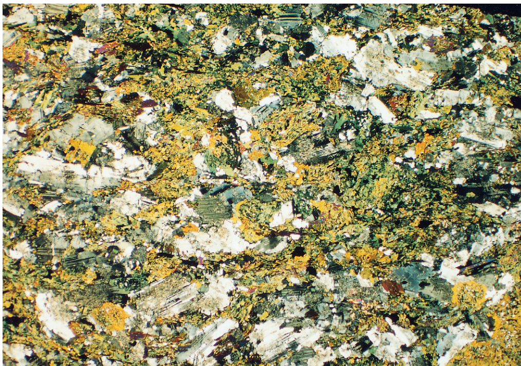
Fig. 3. Metabasit. Mikroskopbild av tunnslip. Förstoring 12x. Dominerande mineral är amfibol (grön eller gul färg på bilden) och plagioklas (ljusgrå till vit). Ulvasjömåla (8a), 624419/150109.
