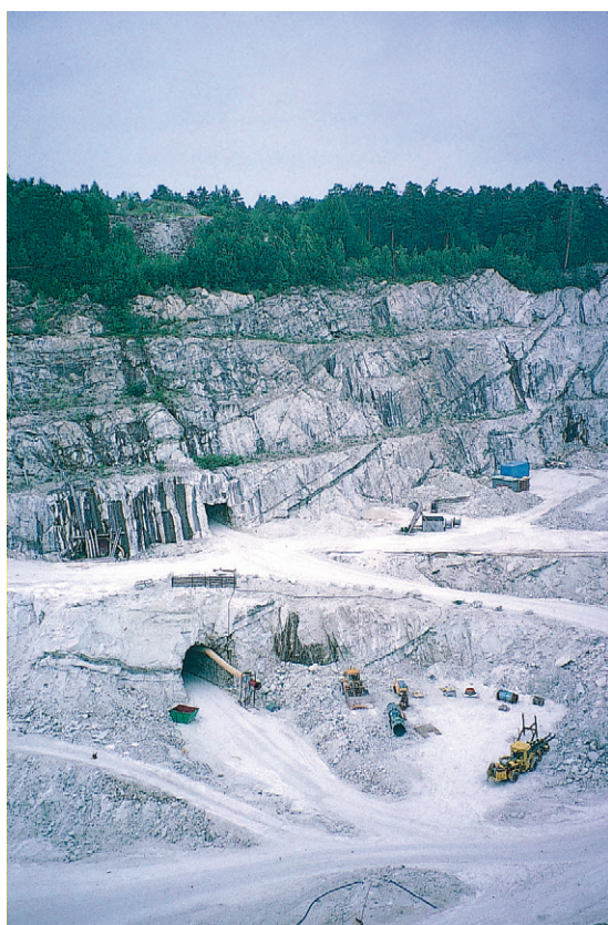
Fig. 3. Tistbrottet i Sala (664340/154260). Här bryts dolomit under jord.
