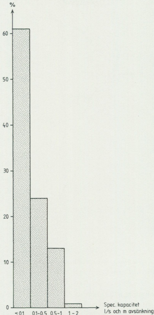
Fig. 3. Fördelning av den specifika kapaciteten i Kågerödsformationen. Baserad på 54 brunnar med 110–300 mm diameter.
