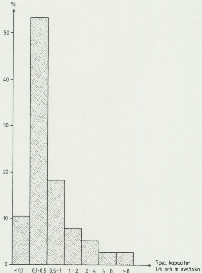
Fig. 7. Fördelning av den specifika kapaciteten för 77 brunnar med 150–400 mm diameter i undre jura-rätberggrunden.
