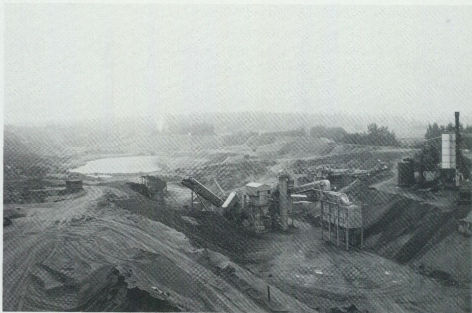
Fig. 21. Grusbrytning under grundvattenytan i Strömsholmsåsen vid Folkesta (7g). Foto P. Engqvist. Gravel mining under groundwater level in the esker Strömsholmsåsen at Folkesta (7g).
