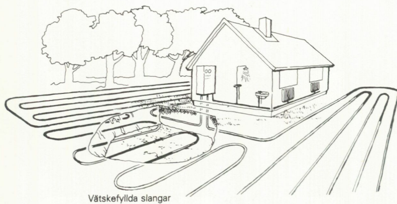
Fig. 7. Ytjordvärme Surface soil heat
