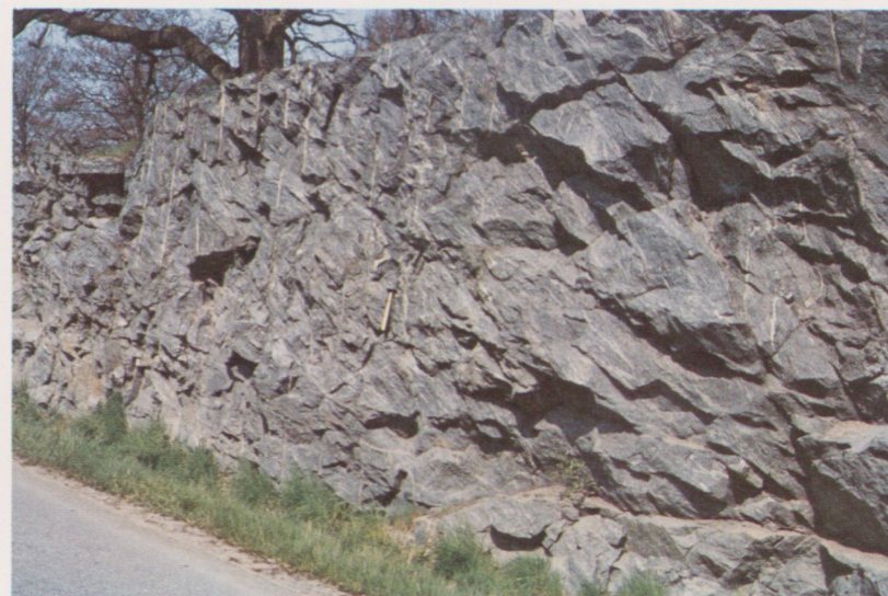
Oregelbunden sprickighet i Blekinge kustgnejs. 3 km V Nättraby. Stupning 45° mot Ö. Irregular fractures in Blekinge coastal gneiss. 3 km W Nättraby. Dipping 45° towards E.
