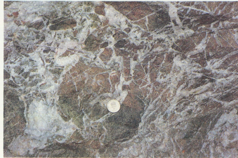
Kvartsläkt breccia. Sådana uppträder ofta i och intill större sprickzoner i berggrunden. Väg 55 vid Lagnö. Foto C.-F. Müllern. Quartz cemented breccia. These are often found in or close to major fracture zones in the bedrock.
