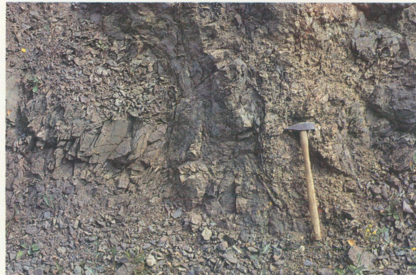
Detalj av starkt uppkrossad förkastningszon. Om förändringen av berggrunden gått så långt som till leromvandling, kan även stora krosszoner vara dåligt vattenförande. 2 km SO om Ärla kyrka. Foto C.-F. Müllern. Detail of heavily crushed fault zone. If the bedrock has been altered as much as to clay, even large fracture zones may yield very little water.
